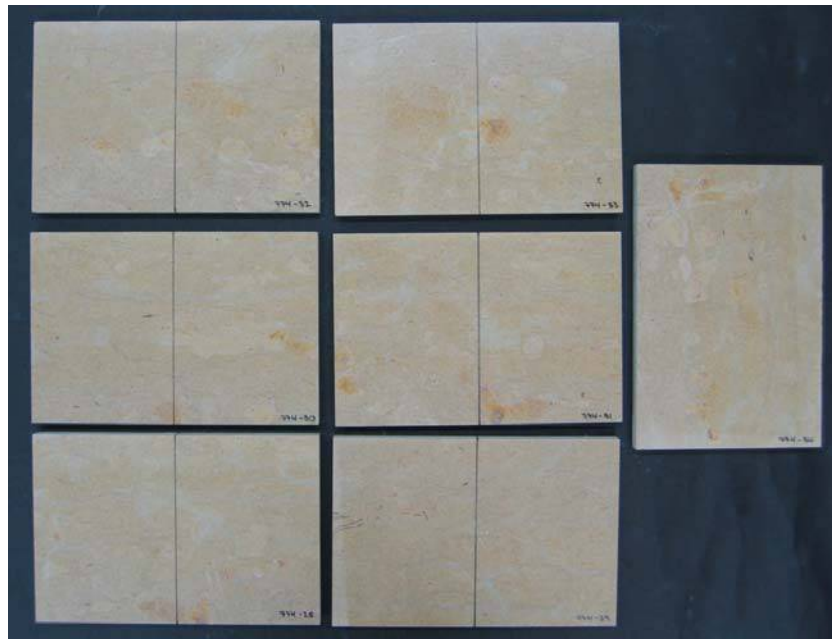
Muestra antes de ciclos de choque térmico Sample before thermal shock cycles
