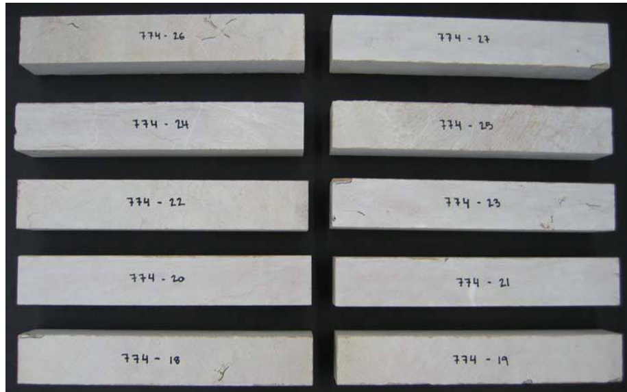
Lote 2 antes de ciclos de hielo–deshielo Set 2 before freeze-thaw cycles
